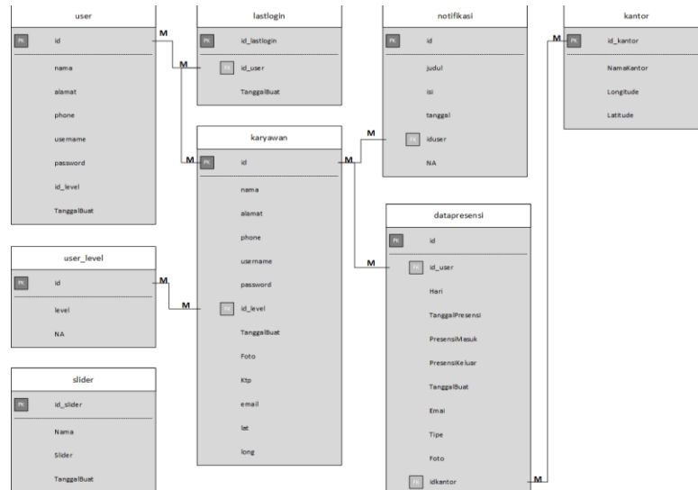
Gambar 5 Class Diagram Sistem yang diajukan untuk presensi karyawan
